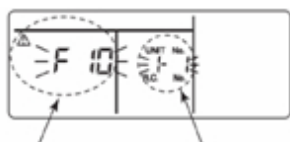
Kod błędu Nr jednostki wewnętrznej, w której wystąpił błąd
